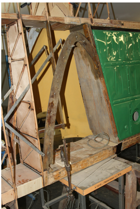
Travail de présentation des carénages de fuseaux moteurs et train escamotable sur l'aile du Bobcat .
