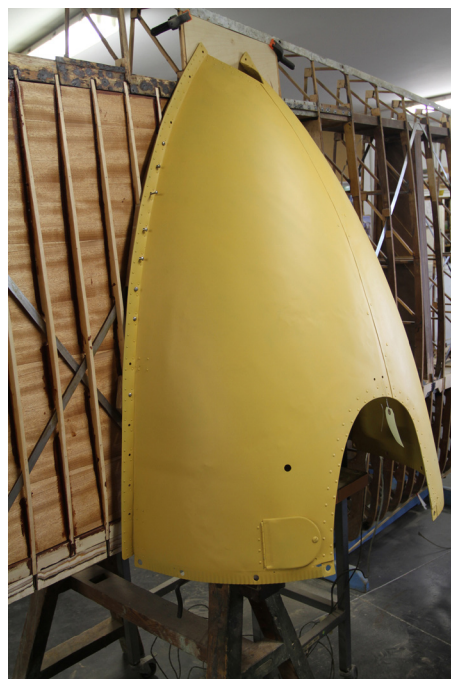
Travail de présentation des carénages de fuseaux moteurs et train escamotable sur l'aile du Bobcat .
